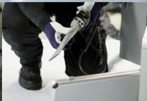
Trockeneis, das ist  $\text{CO}_2$  in verfestigter Form. Beim revolutionären Strahlverfahren des Trockeneisstrahlens werden Trockeneispellets als Strahlmittel benutzt. Diese Alternative ist besonders umweltfreundlich, schonend und zudem noch effektiver als die herkömmlichen industriellen Reinigungsmethoden. Ausserdem produzieren wir auch Pellets und Nuggets aus Trockeneis für Sie, welches Sie für effektive Kühlung verwenden können.
